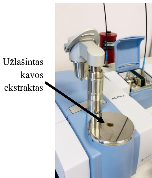
14 pav. Užlašintas kavos ekstraktas ant ATR kristalo.
