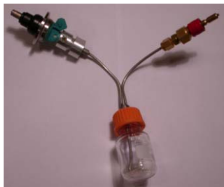
29 pav. MO junginių tirpalo injekcijos į garintuvą sistema, apjungianti injektoriu, tirpalo rezervuarą ir specialią jungtį su inertinių dujų linija.
