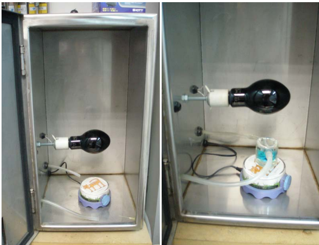
34 pav. Kairėje - nerūdijančio plieno konteineris, kuriame įmontuotas šviesos šaltinis ir magnetinis maišiklis. Dešinėje - reakcijos indas su fotokatalizatoriaus pavyzdžiu ir metileno mėlio tirpalu.
