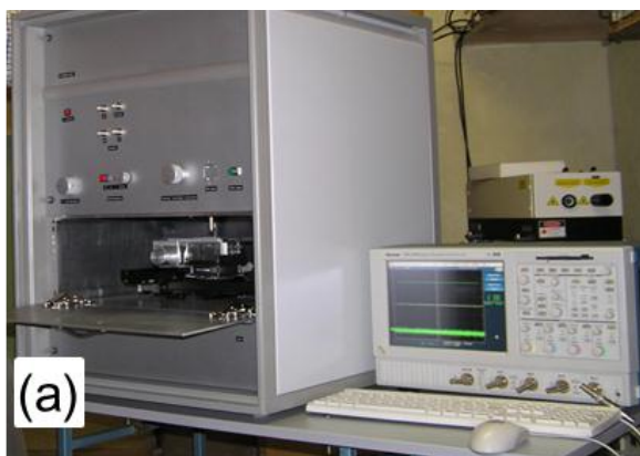
2 pav. Daugiavfunkcinis prietaisas planariniam ir skersiniam rekombinacijos trukmių pasiskirstymui matuoti.
