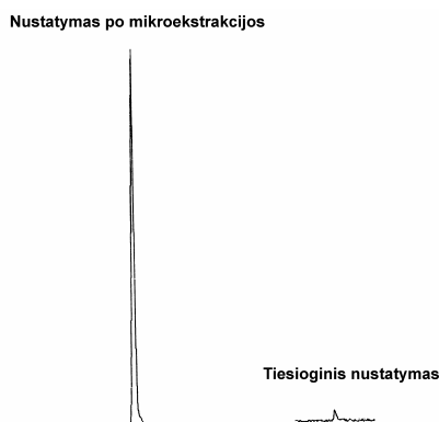
3.19 pav. Cianido standarto (0,02 mmol/L) smailės po mikroekstrakcijos ir įleidžiant tą patį standartą (po derivatizacijos \text{Ni}^{2+} jonais) tiesiogiai be mikroekstrakcijos.
