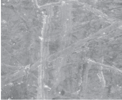
2.33 pav. Bandinio p-por-Si paviršiaus SEM nuotrauka. Porfirinas jau interkaliuotas. HF:C 2 H 5 OH=1:1, j=30 mA/cm 2 , t=60 min., šviečiama iš apačios, nevalytas KOH.
