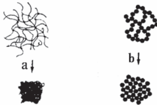
4.2 pav. Zolio ir išdžiūvusio gelio schema su rūgštiniu (pH<2) (a) ir šarminiu (pH>5) (b) katalizatoriumi [111].
