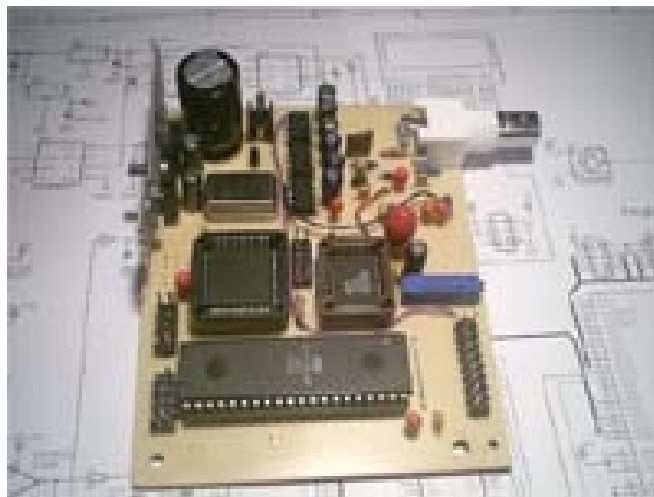
1.3 pav. Realiai surinktos oscilografo mikrovaldiklio ATMEGA162 pagrindu plokštės vaizdas
