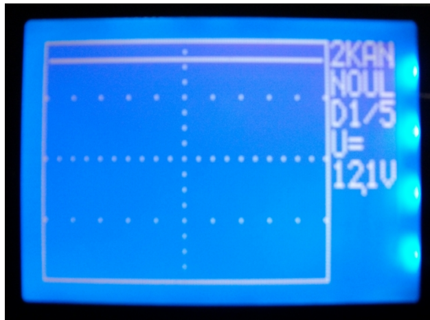
7.11 pav. Matuojama nuolatinė įtampa ir daliklis įjungtas
