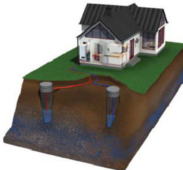
12 pav. Gruntinio vandens sistema
