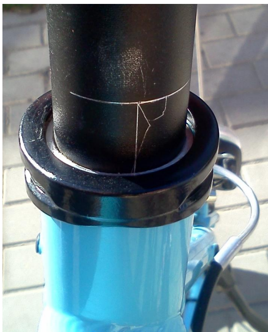
3.4 pav. Dėl tinkamai neišvalyto vamzdžio subraižytas balnelio laikiklis.
