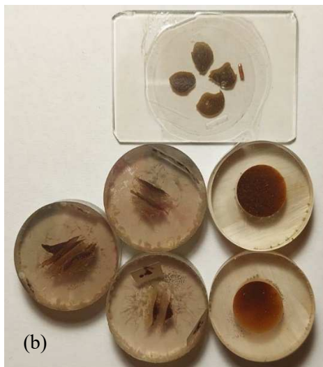
2.4 pav. Kokybinės mineralinės gruntų sudėties tyrimas: (a) skenuojantis elektroninis mikroskopas; (b) šlifai, pagaminti Fizinių ir technologijos mokslų centre ir „Thin Section Lab“ laboratorijoje
