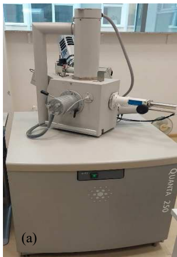
2.4 pav. Kokybinės mineralinės gruntų sudėties tyrimas: (a) skenuojantis elektroninis mikroskopas; (b) šlifai, pagaminti Fizinių ir technologijos mokslų centre ir „Thin Section Lab“ laboratorijoje
