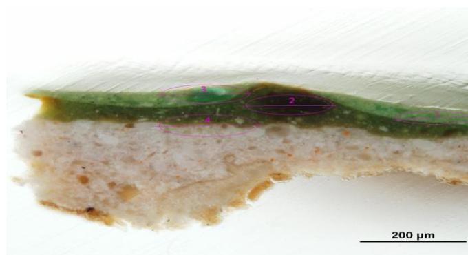
35 pav. Žalių dažų mėginio \mu XRD analizės schema
