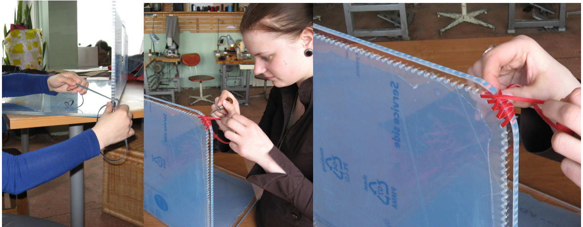
81-83 pav. Odinėmis juostelėmis varstomas stiklo kraštas paslepiamojo krašto apipynimu
