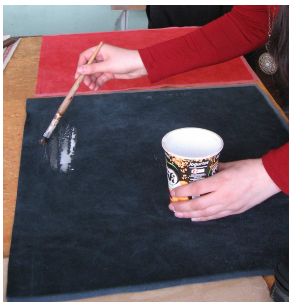
88 pav. Su klijų lipalas ir vandens padarytu mišiniu įklyninamos odos detalės
