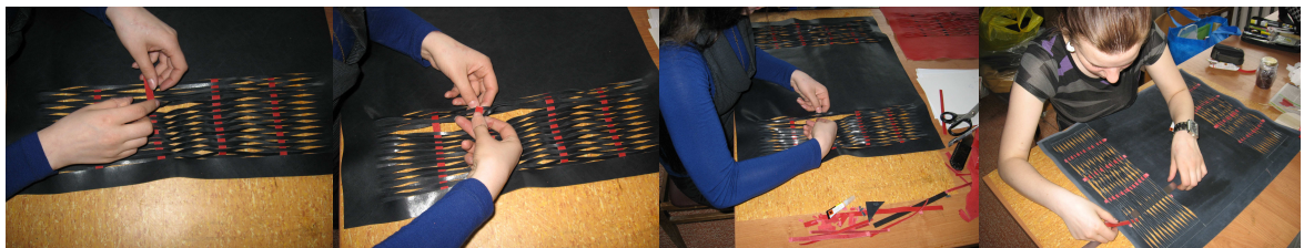
93-96 pav. Pinama odos detalė su juostelių sukeitimo būdu
