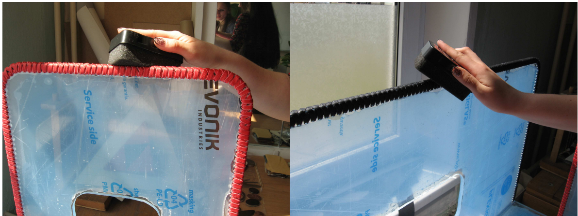
84-85 pav. Kempinėle su vašku važkuojami apipinti abiejų stiklų kraštai
