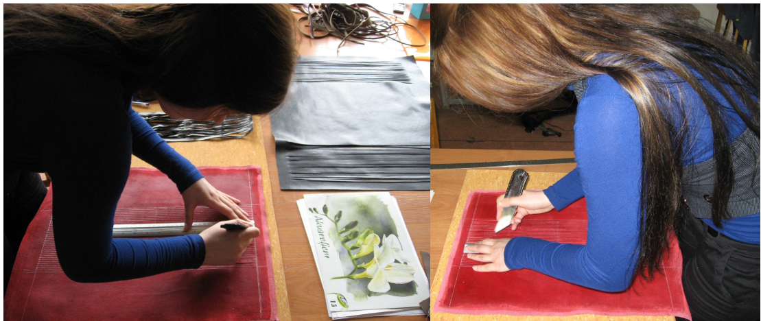
91-92 pav. Su peiliu pjaunamos įpjovos odoje padarytų žymų vietose, kad įpjovos būtų tiesios pjaunama su liniuotės pagalba
