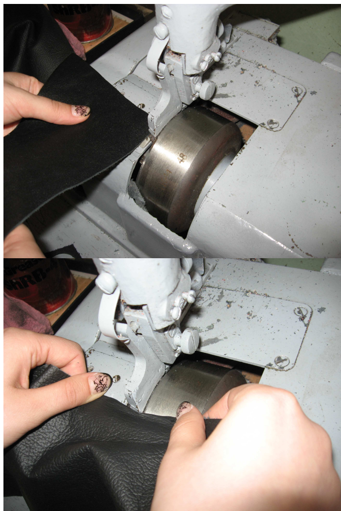
86-87 pav. Su kraštelių sklembimo mašina nusklembiami odinių detalių kraštai
