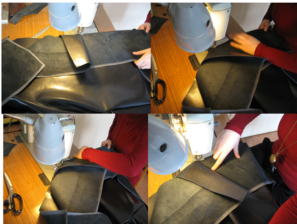
99-102 pav. Su siuvimo mašina siuvamos odos detalės
