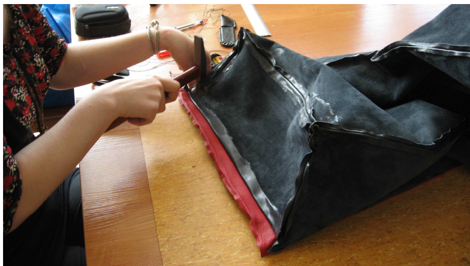
103 pav. Su metaliniu plaktuku atkalamos siūlės iš vidinės odos pusės
