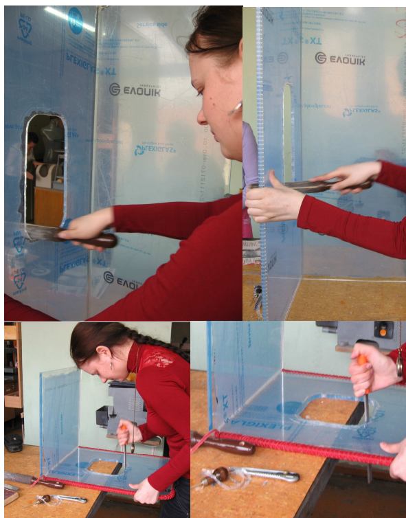
77-80 pav. Šlifuojama stiklo vidinė išima su metaline dilde ir šlifavimo popieriumi
