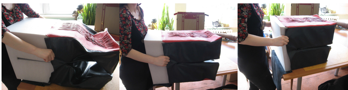
104-106 pav. Aptraukiama porolono detalė rankiniu būdu su odiniu užvalkalu
