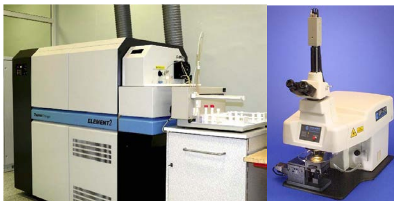
2.1 pav. Darbe naudotas induktyviai sužadintos plazmos masių spektrometras ELEMENT2 (kairėje) ir lazerinio išgarinimo mėginių įleidimo sistema (dešinėje).
