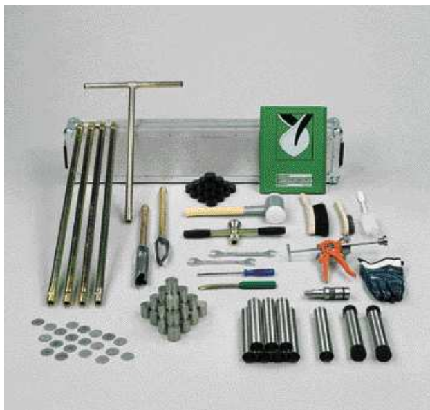
4 pav. Darbe panaudota nesuardytos sandaros grunto ėminių paėmimo įranga (nuotrauka iš http://www.surechem.com.my/download/eijkelkamp/P1/P1-30e.pdf ).
