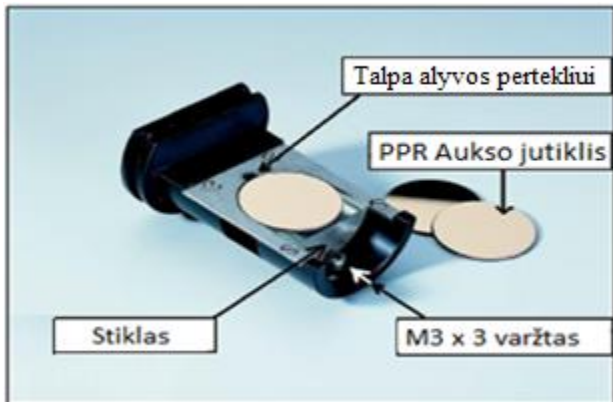
15 pav. Tyrime naudotų PPR lustų laikiklis [26].
