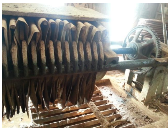
8 pav. Vandens išsunkimas iš molio pienelio (kairė) ir išsunkto molio diskai (dešinė).
