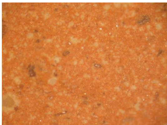
22 pav. Šiuolaikinės keramikos paviršiaus optinės mikroskopijos nuotrauka (didinimas 50 x).
