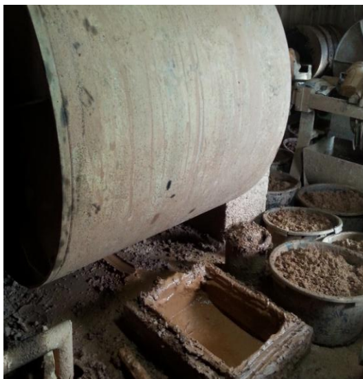
7 pav. Būgnas, kuriame skiedžiamas molis ir šulinys, kuriame filtruojamas molio pienelis.
