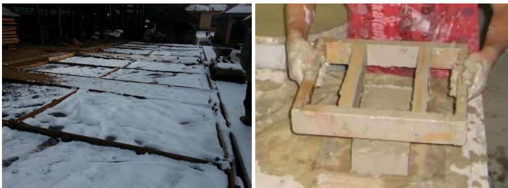
9 pav. 60 cm gylio molio brandinimo baseinai (kairė) ir plytos formavimas medine forma (dešinė).
