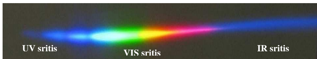
3.39 pav. Vaizdas ekrane po 5 barų argono dujose gijos formavimosi. Spinduliuotės spektras praskleistas difrakcine gardele
