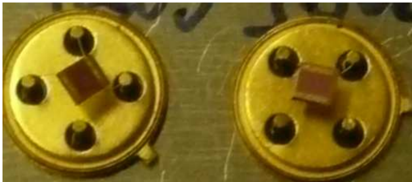
3.22 pav. \text{SnO}_x sluoksnių pagrindu pagaminti dujų jutikliai įtvirtinti laikikliuose ir paruošti darbui.
