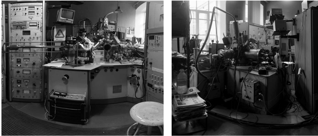
2.3.2 pav. RIBER LAS-3000 XPS spektrometras.
