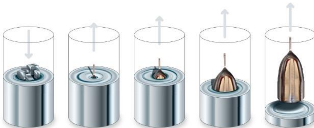
Pav. 8: Vienfazių kristalų gavimo iš lydalo proceso schema [41]. Polikristalinis junginys išlydomas ir naudojant pradinį monokristalą išauginamas vientisas kristalas.
