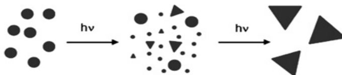
6 pav. Fotocheminės AgNp sintezės schema [26]
