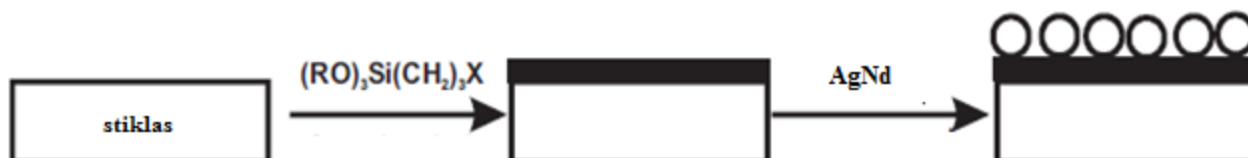
11 pav. Savaiminio Nd nusodinimo schema. X=CN, NH 2 , 2-piridil, P(C 6 H 5 ) 2 arba SH; R=CH 3 arba CH 2 CH 3 [32].
