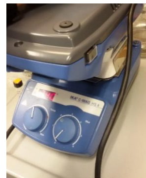
10 pav. Bandinys kaitinamas 240^{\circ}\text{C} temp.
