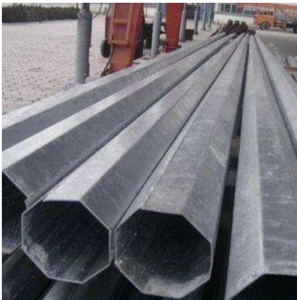
1.5 pav. Plieniniai atramų ruošiniai po karšto cinkavimo
