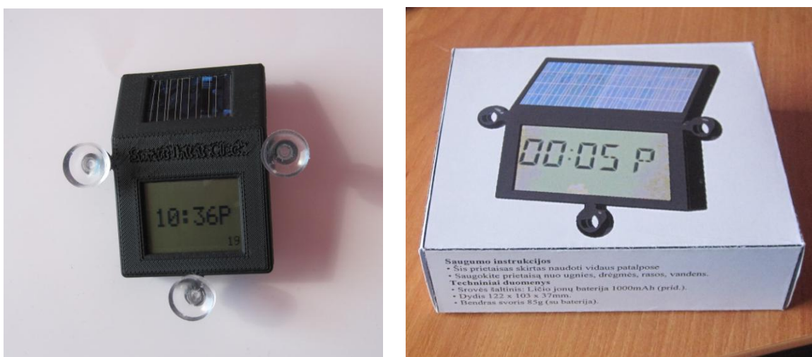
Figūra 12 Elektroninio automobilių parkavimo laikrodžio prototipas, bei pakavimo dėžutė
