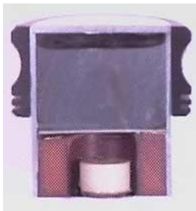
26 pav. Signalų keitiklio skersinis pjūvis (matomas aktyvusis elementas).
