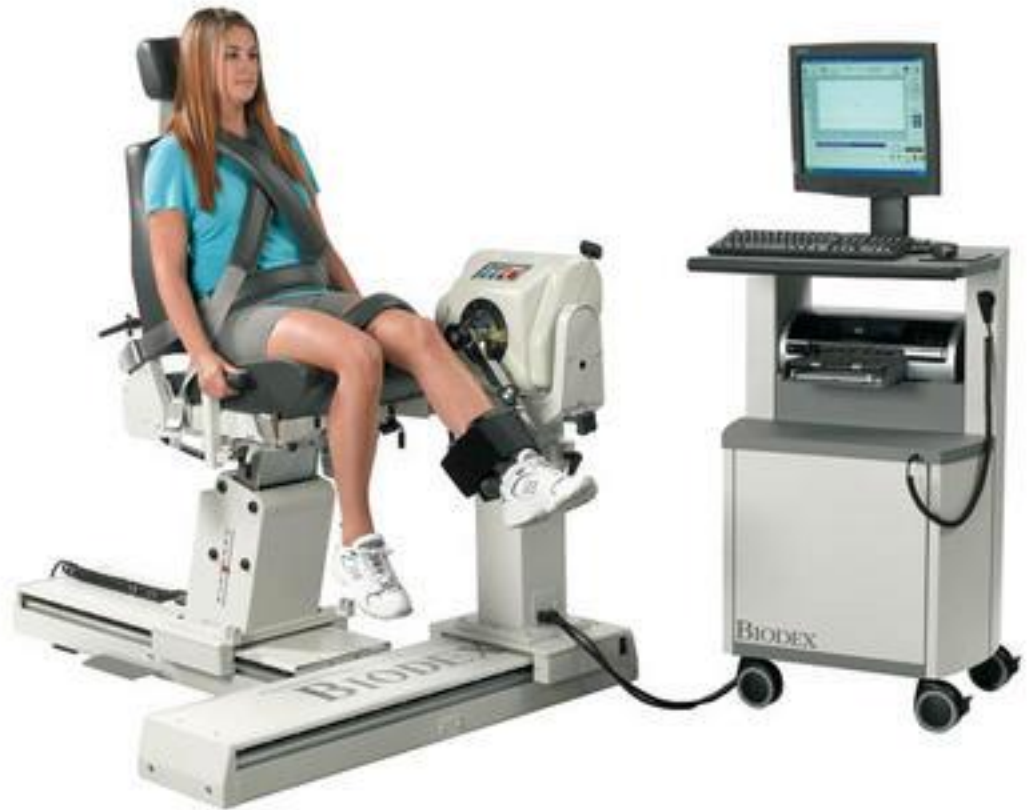
4 pav. Biodex System Pro 4 Kelio lenkiamųjų ir tiesiamųjų raumenų jėgai vertinti įranga.
