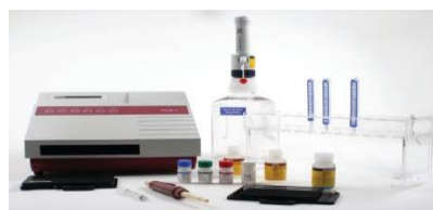
3 pav. MAST CLA-I TM liuminescencinis analizatorius ir priedai ( angl. The CLA® Allergen-Specific IgE Assay )
