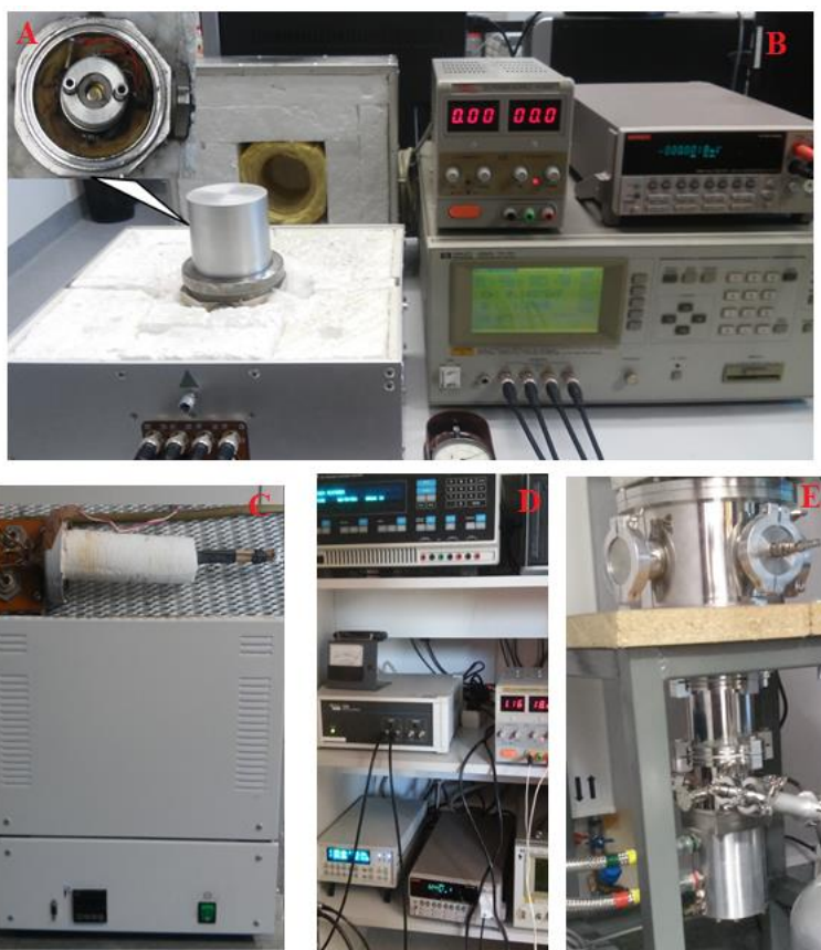
3.1 pav. Žemų dažnių dielektrinių matavimų struktūrinė schema (A – matuojamo bandinio vieta; B – matavimo įranga; C – elektrinė krosnelė su bandinio laikikliu; D – kriostato matavimo įranga; E – kriostatas)
