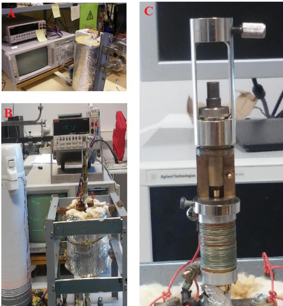
3.2 pav. Bendrašės linijos matavimo stendo struktūrinė schema (A ir B – matavimo įranga; C – matuojamo bandinio vieta)
