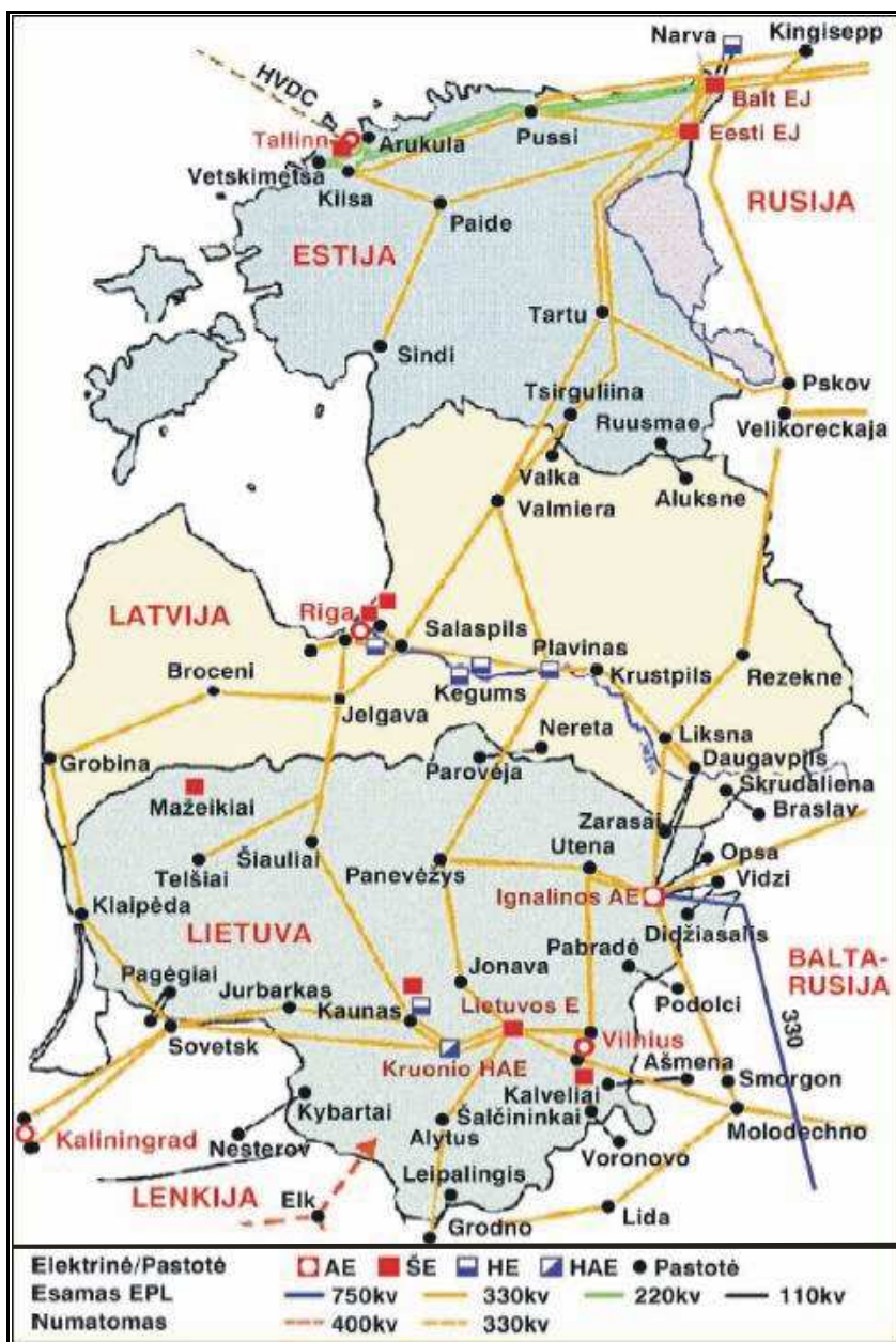
16 pav. Baltijos valstybių elektros energijos perdavimo tinklų schema. (Nacionalinė energetikos strategija, 2002).
