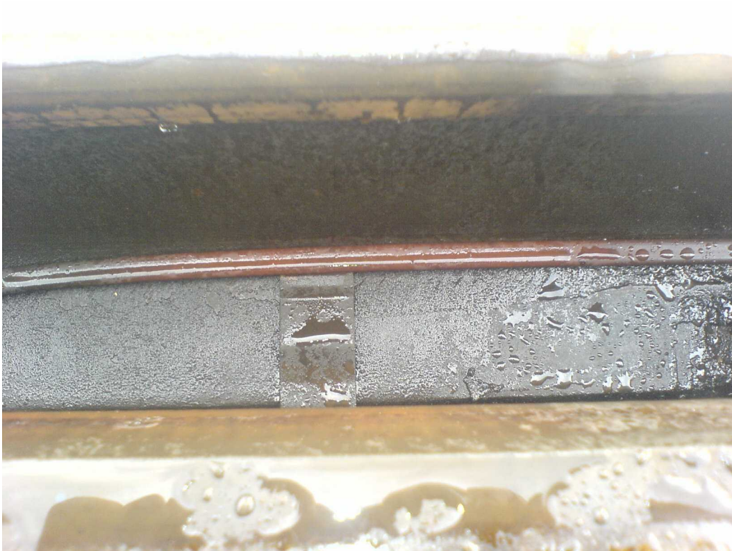
3.6 pav. apkaba nelaiko kaitinimo elemento.
