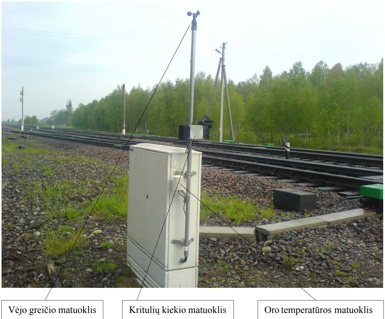
3.2 pav. šildymo sistemos meteorologinių matavimų įrenginys.
