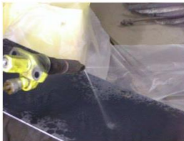
2pav. Geras ir blogas kuro išpurškimas iš purkštuko (iš kairės į dešinę) [19]
