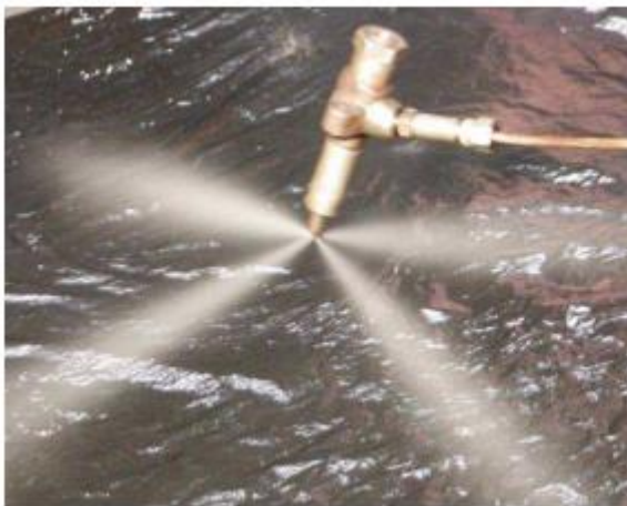
2pav. Geras ir blogas kuro išpurškimas iš purkštuko (iš kairės į dešinę) [19]
