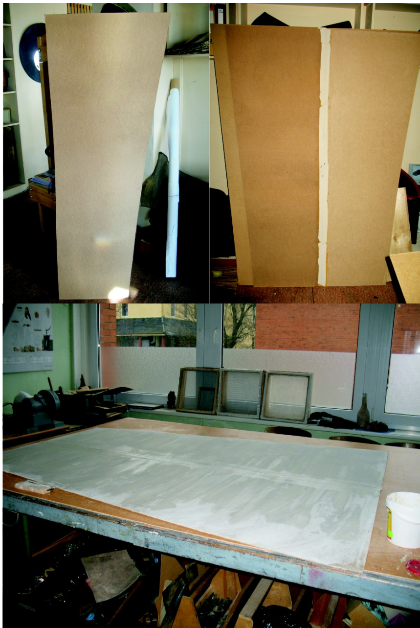
Pav. 35 pagrindo plokščių klijavimas ir gruntavimas
