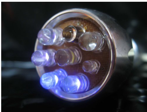
6 paveikslas. Šviesos šaltinis, skleidžiantis 7 skirtingų bangos ilgių šviesą
