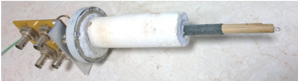
4.1 pav. Žemadažnis aukštų temperatūrų kriostatas.
