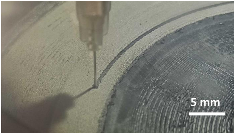
43 pav. Tolygus nusiurbtų metalo dalelių takelis
