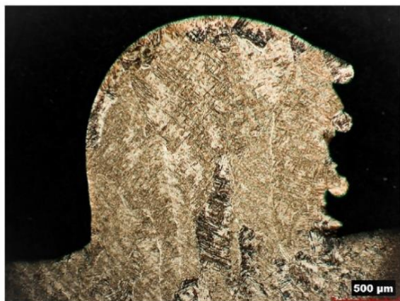
11 pav. Ti-6Al-4V nusodinto takelio skersinis pjūvis [32]
