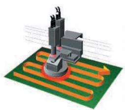
2 pav. Kamera fotografuoja atskirus gaminio segmentus
