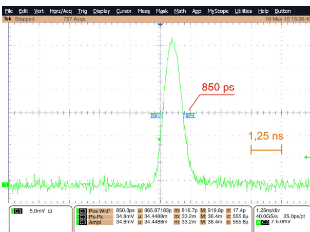
2.2.11 pav. Pasyviosios kokybės moduliacijos Nd:YAG lazerio impulso oscilograma. Išmatuota skaitmeniniu oscilografu (TDS6124C, Tektronix).
