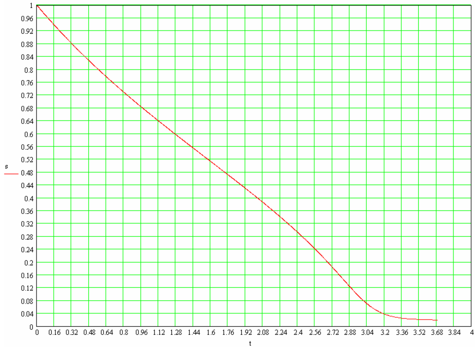
1pav. Asinchroninio variklio slydimo priklausomybė nuo paleidimo trukmės s=f(t)
