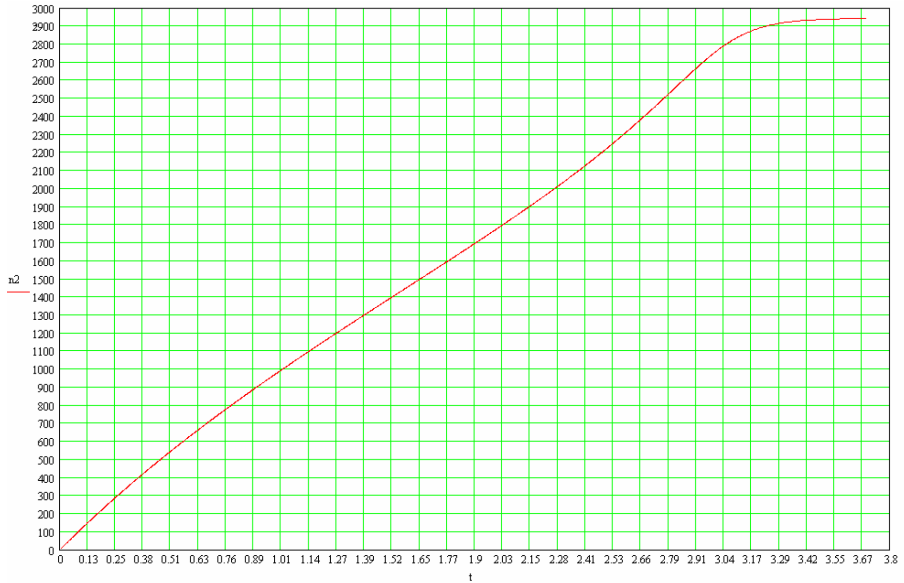
2pav. Asinchroninio variklio greičio priklausomybė nuo paleidimo trukmės n_2=f(t)
