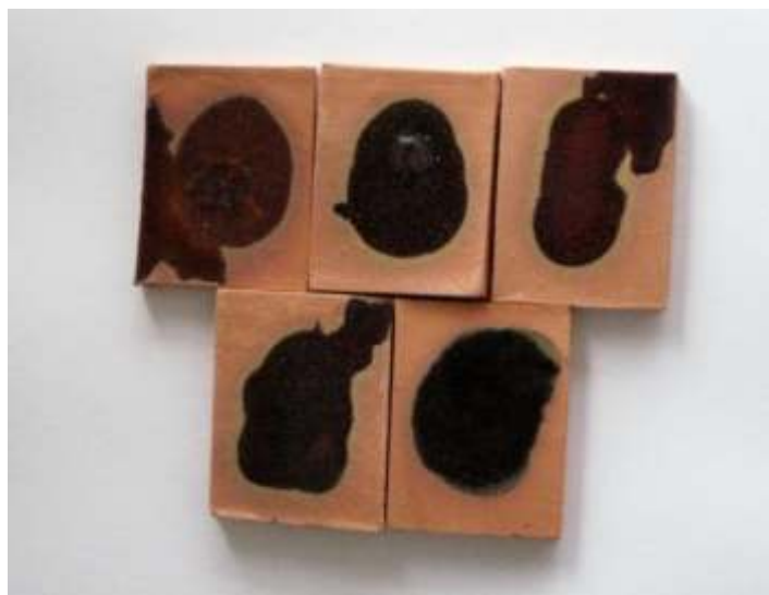
82 pav. Glazūros ( \text{YFeO}_3 (viršuje kairėje), \text{Y}_3\text{Fe}_5\text{O}_{12} (viršuje viduryje), \text{ZnFe}_2\text{O}_4 (viršuje dešinėje), \text{NiFe}_2\text{O}_4 (apačioje kairėje) ir \text{CoFe}_2\text{O}_4 (apačioje dešinėje)), gautos 800\text{ }^\circ\text{C} temperatūroje.
