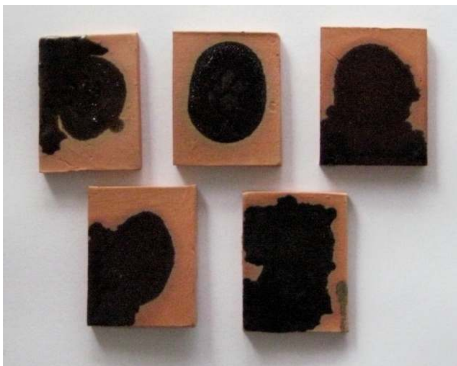
95 pav. Juodosios glazūros ( YFeO_3 (viršuje kairėje), Y_3Fe_5O_{12} (viršuje viduryje), ZnFe_2O_4 (viršuje dešinėje), NiFe_2O_4 (apačioje kairėje) ir CoFe_2O_4 (apačioje dešinėje)), gautos su CuO .
