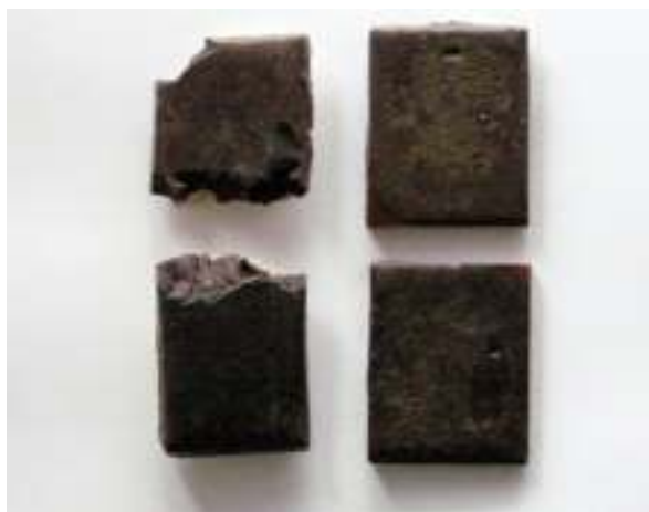
84 pav. Glazūros ( \text{YFeO}_3 (viršuje kairėje), \text{ZnFe}_2\text{O}_4 (viršuje dešinėje), \text{NiFe}_2\text{O}_4 (apačioje kairėje), \text{CoFe}_2\text{O}_4 (apačioje dešinėje)), gautos 1000 °C temperatūroje.
