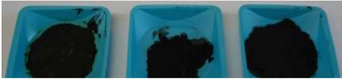
24 pav. Aliejinių dažų, pagamintų iš C suodžių ir \text{CaCO}_3 su linų aliejumi, esant skirtingiems santykiams (iš kairės): 1:1; 1:0,1; 1:0,01, nuotrauka.
