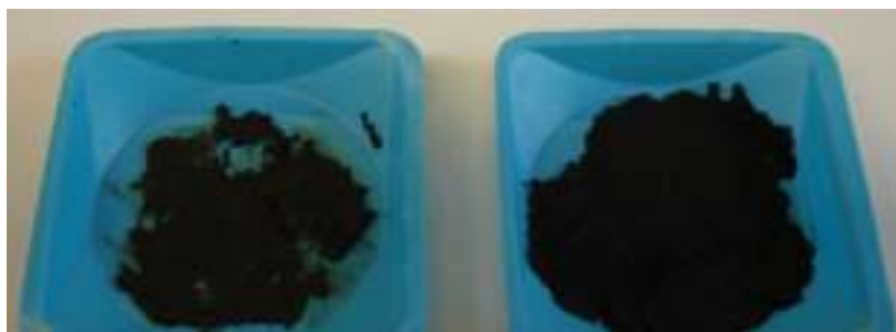
36 pav. Aliejinių dažų, pagamintų iš C suodžių ir Ca_3(PO_4)_2 , CaCO_3 , Mg_3(PO_4)_2 su linų aliejumi esant skirtingiems santykiams (iš kairės): 1:1:1:1 ir 1:0,01:0,01:0,01, nuotrauka.
