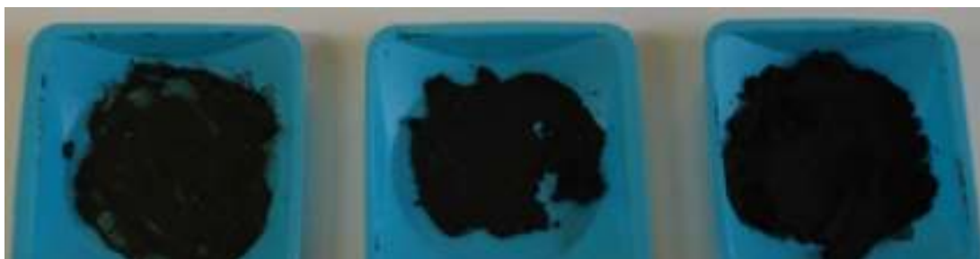
27 pav. Aliejinių dažų, pagamintų iš C suodžių ir Ca 3 (PO 4 ) 2 , CaCO 3 su linų aliejumi esant skirtingiems santykiams (iš kairės): 1:1:1; 1:0,1:0,1; 1:0,01:0,01, nuotrauka.
