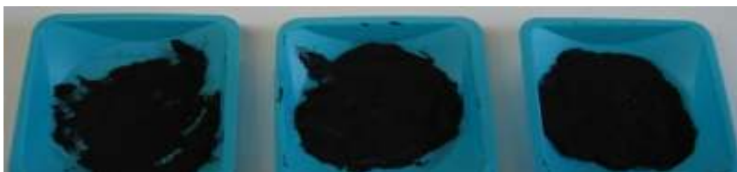
30 pav. Aliejinių dažų, pagamintų iš C suodžių ir \text{Ca}_3(\text{PO}_4)_2 , \text{Mg}_3(\text{PO}_4)_2 su linų aliejumi esant skirtingiems santykiams (iš kairės): 1:1:1 ; 1:0,1:0,1 ; 1:0,01:0,01 , nuotrauka.
