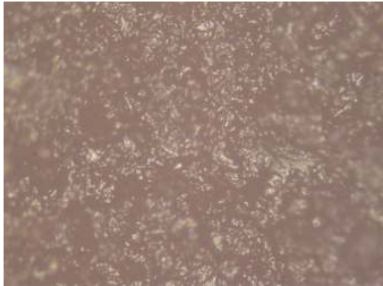
34 pav. Aliejinio juodojo dažo, kuriame \text{C} : \text{CaCO}_3 : \text{Mg}_3(\text{PO}_4)_2 = 1:0,01:0,01 , optinio mikroskopo nuotrauka.
