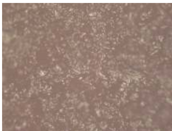
31 pav. Aliejinio juodojo dažo, kuriame C : \text{Ca}_3(\text{PO}_4)_2 : \text{Mg}_3(\text{PO}_4)_2 = 1:0,01:0,01 , optinio mikroskopo nuotrauka.
