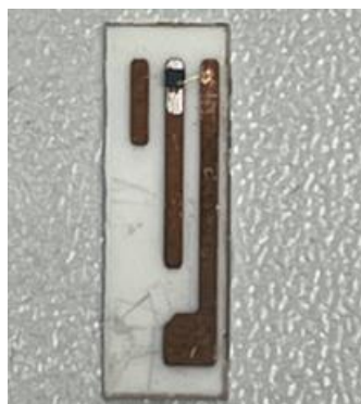
10 pav. Bandinio ant plastikinio padėkliuko nuotrauka. Vizualinio skirtumo tarp nešvitintų ir apšvitintų bandinių nesimatė.
