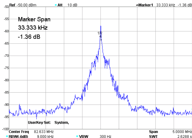
30 paveikslas. Tiriamo derinamo bangos ilgio lazerio spektro plotis su 450m užlaikymo linija spinduliuojant 1550nm spektrą.
