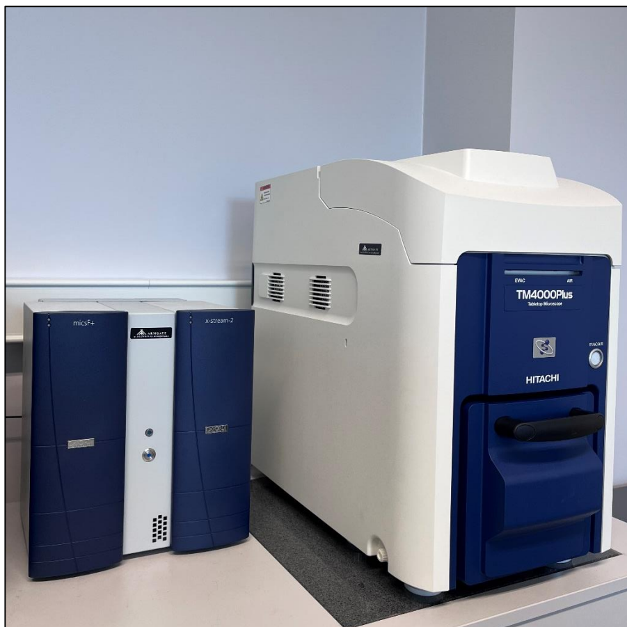
8 pav. TM4000Plus Tabletop Microscope HITACHI (SEM, dešinėje) ir micF+ x-stream-2 Oxford Instruments (EDS, kairėje) naudota įranga
