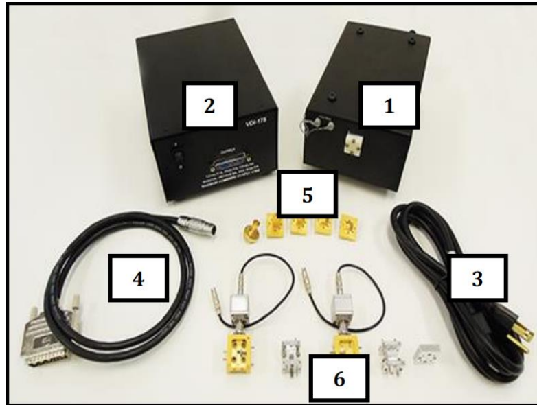
18 pav. VDI AMC 448 bangų stiprintuvo sudedamosios dalys [31]
