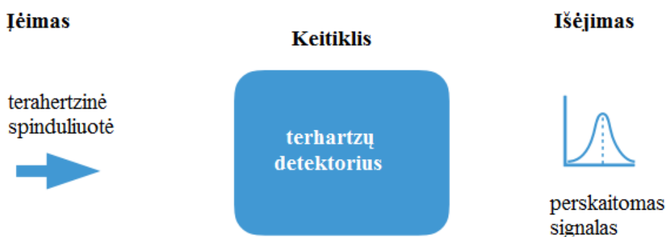
1 pav. Bendroji terahercų detektoriaus schema. Terahercų detektorius yra keitiklis, kuris terahercų spinduliuote pakeičia į perskaitomą signalą [8]
