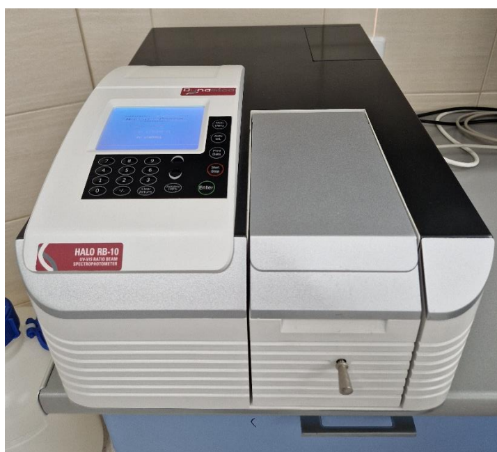
15 pav. Dynamica Halo RB-10 spektrofotometras naudotas tyrimui.
