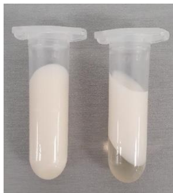
16 pav. Kairėje pusėje pavaizduota stabili pusiau kieta farmacinė forma. Dešinėje – išsiskyrusios aliejinė ir vandeninė fazės E 6 pusketėje farmacinėje formoje.
