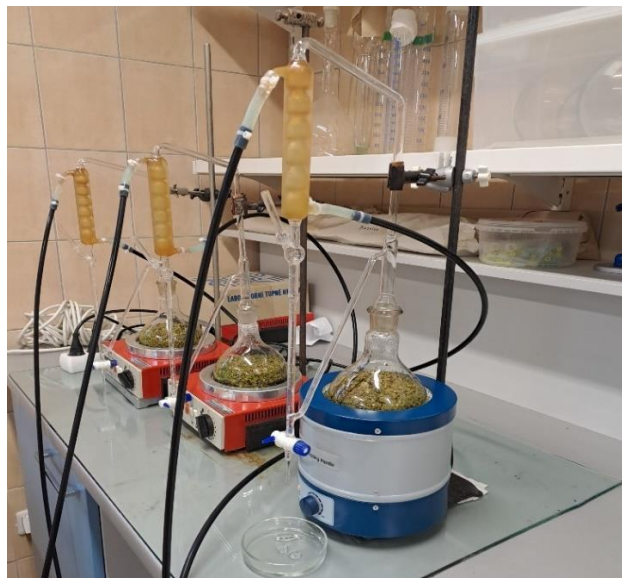
4 pav. Thymus pulegioides žaliavos distiliavimas Klevengerio tipo aparatūra (asmeninis archyvas)
