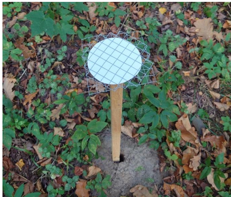
15 pav. Tyrime naudota pasyvi sporų gaudyklė (autorės nuotr.)
