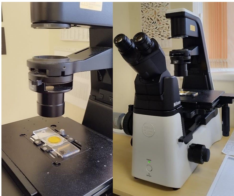
4 pav. Invertuotas binokuliarinis mikroskopas „Nikon Eclipse Ts2R“ naudotas atlikti fitoplanktono mėginių tyrimus.
