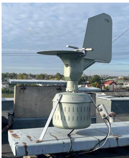
2 pav. Šiaulių aerobiologinės stotelės Hirst tipo tūrinė žiedadulkių ir sporų gaudyklė
