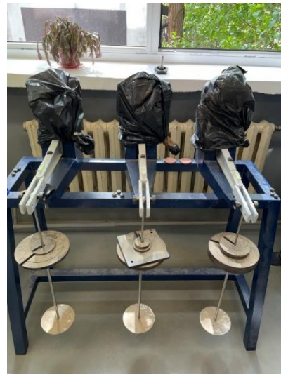
16 pav. Tankinimas prie skirtingų apkrovų 100kPa, 200kPa ir 300 kPa (Autoriaus nuotrauka)
