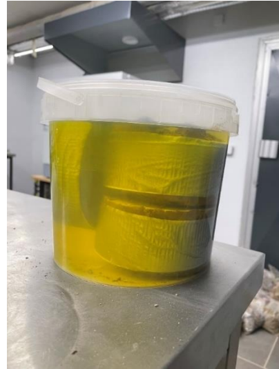
11 pav. Bandinukų rinkinys užmerktas dyzelyje ( Autoriaus nuotrauka )
