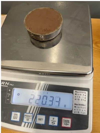
15 pav. Metalinis žiedas užpildytas užterštu moliu sveriamas (Autoriaus nuotrauka)
