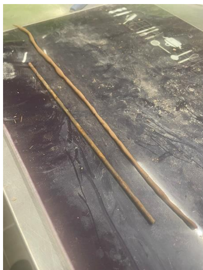
14 pav. Grunto pasta iškošiota iki 3 mm storio, šalia padėta 3 mm metalo strypas (Autoriaus nuotrauka)
