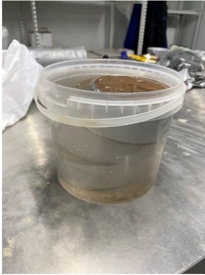
10 pav. Bandinukų rinkinys užmerktas natrio hidrokside ( Autoriaus nuotrauka )
