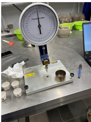
12 pav. Naudotas penetrometras (Autoriaus nuotrauka)
