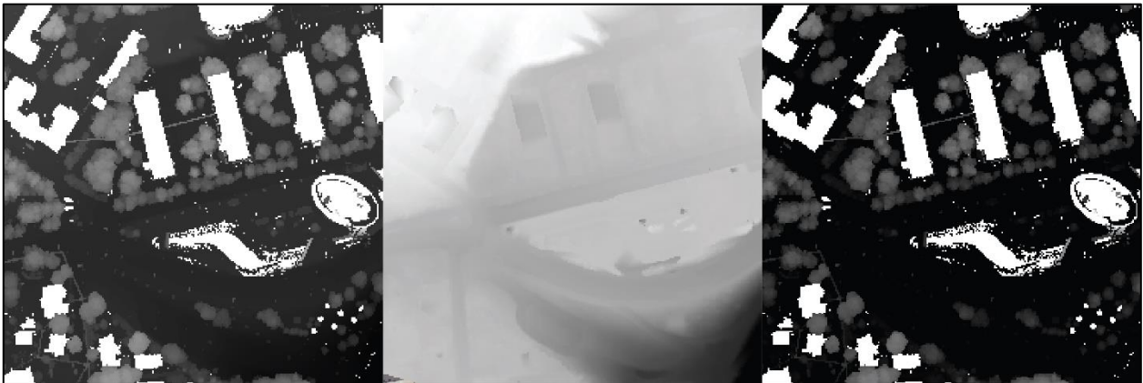
4 pav. Iš kairės į dešinę: 76_32-0165 lapo pirmo atspindžio rastras, žemės paviršiaus rastras ir sugeneruotas CHM.
